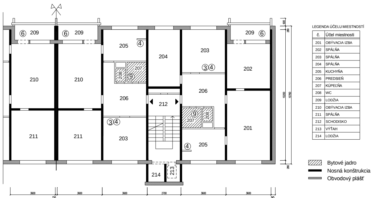
Obr. 4.12.7 Lokalizácia jednoduchých zásahov v radovom dome ZTB
