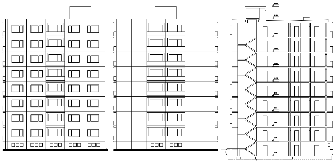
Obr. 4.5.5 Pohľady a rez bodovým domom T 06 B ZA
