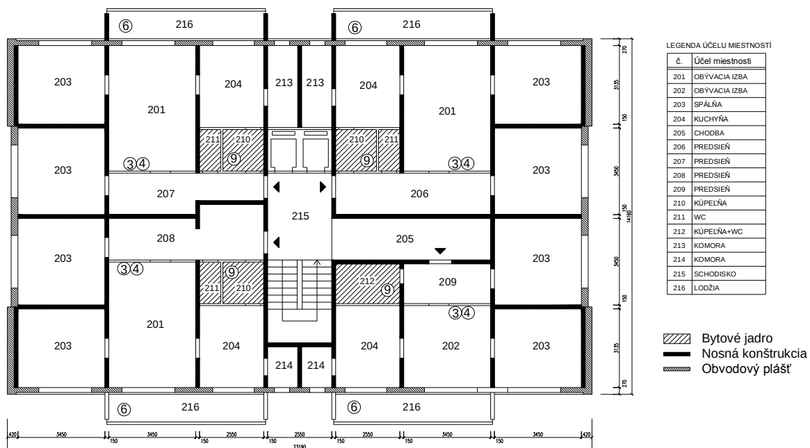
Obr. 4.11.8 Lokalizácia jednoduchých zásahov v bodovom dome ZT
