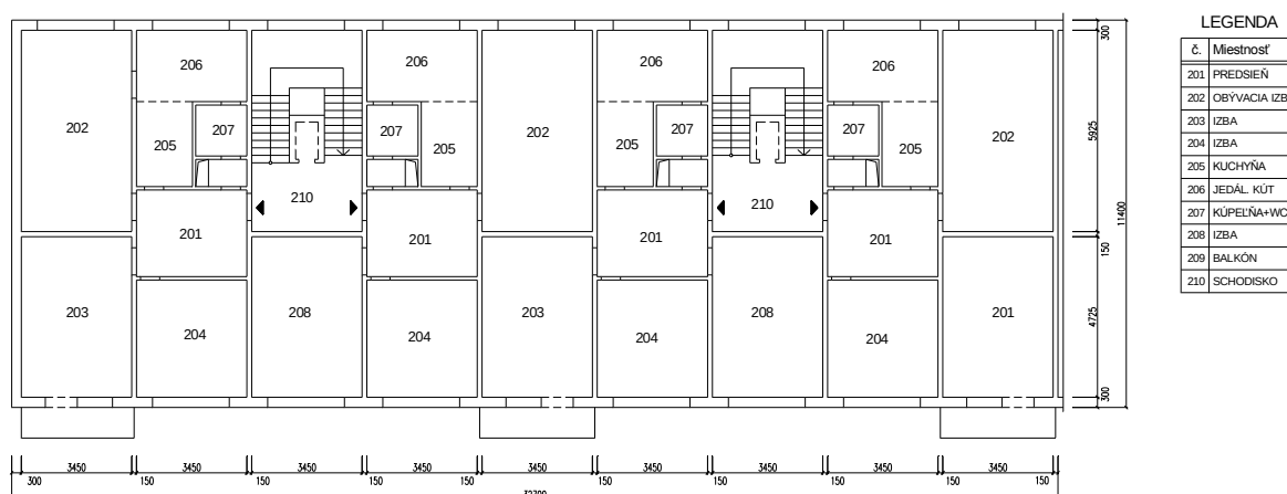
Obr. 4.7.5 Pôdorys typického podlažia radového domu T06B BB
