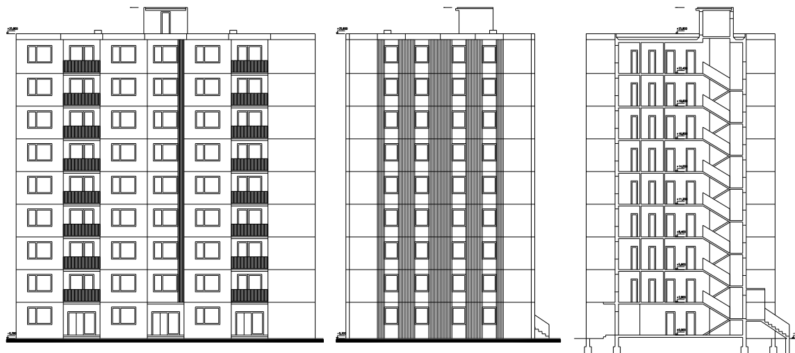
Obr. 4.19.6 Pohľad a rez bodovým domom PS-82-PP
