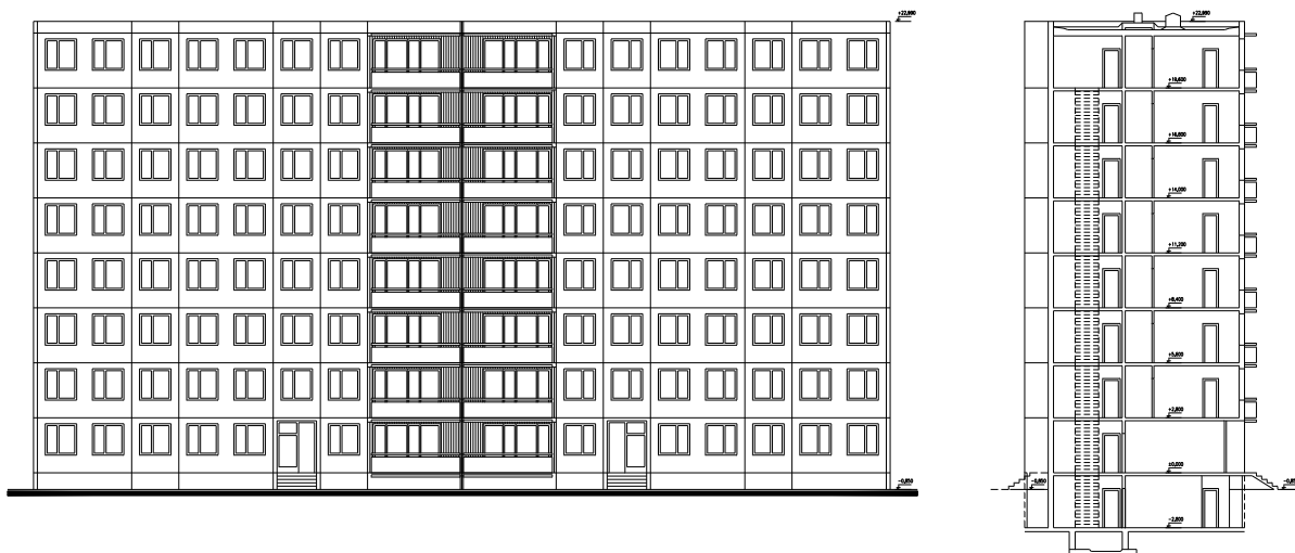
Obr. 4.14.3 Pohľad a rez radovým domom B-70
