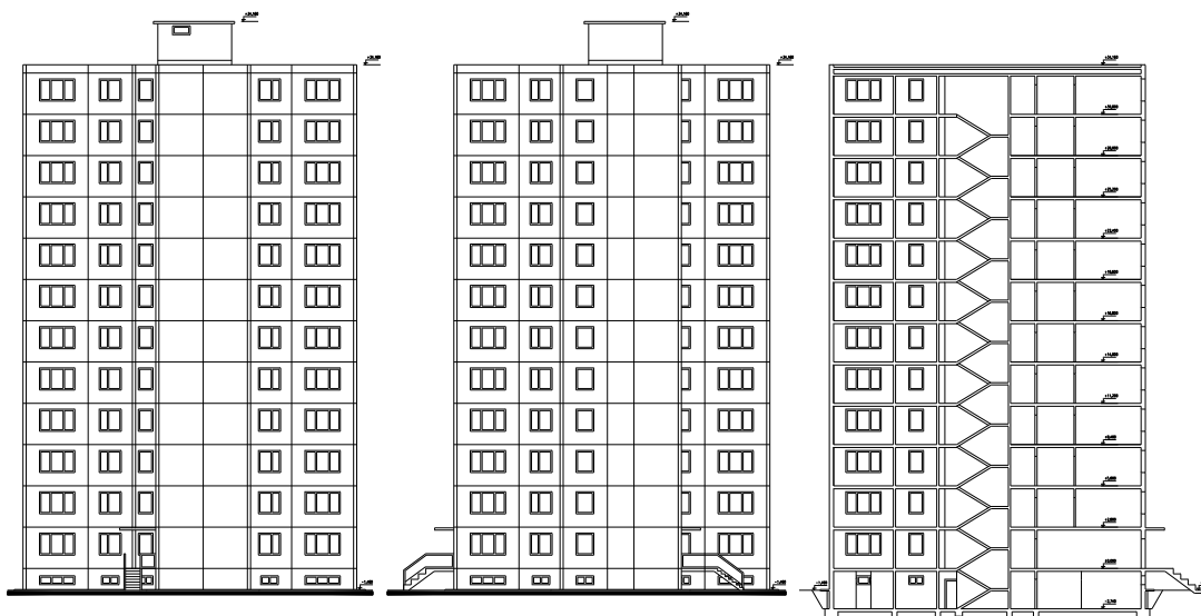
Obr. 4.15.4 Pohľad a rez bodovým domom BA NKS
