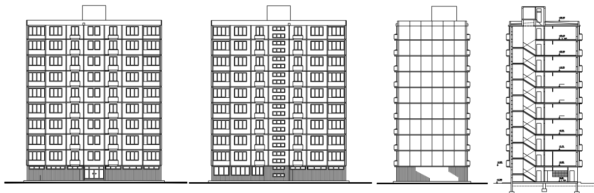
Obr. 4.3.3 Pohľady a rez radovým domom LB
