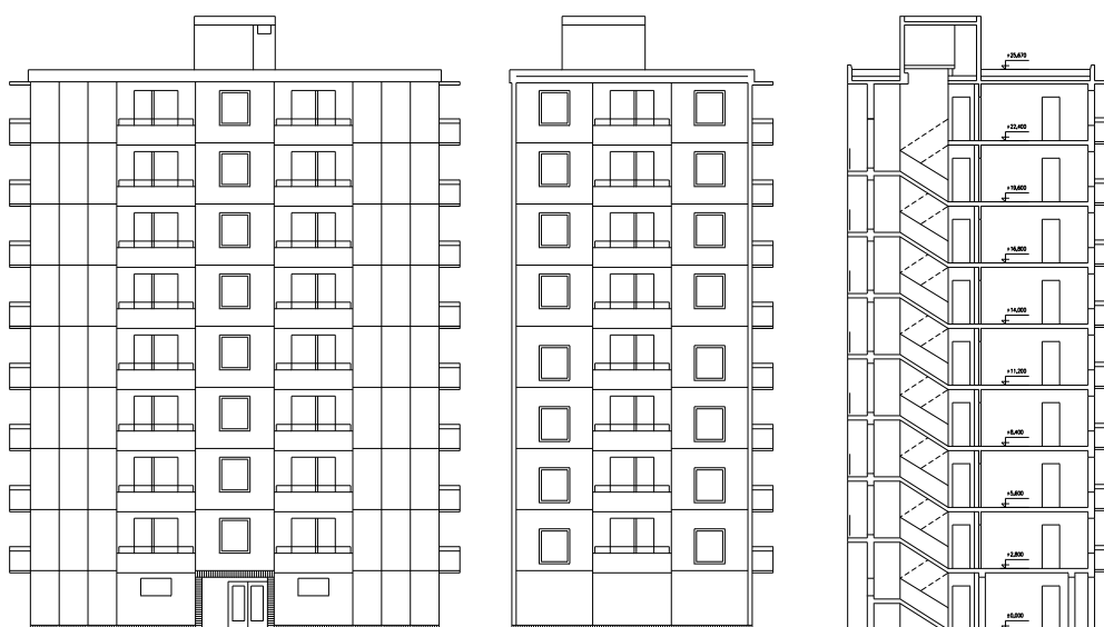
Obr. 4.7.4 Pohľady a rez bodovým domom T06B BB
