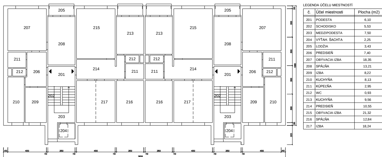
Obr. 4.18.5 Pôdorys typického podlažia radového domu P1.15
