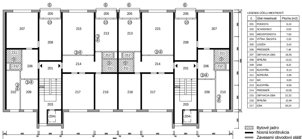
Obr. 4.18.7 Lokalizácia jednoduchých zásahov v bodovom dome P1.15
