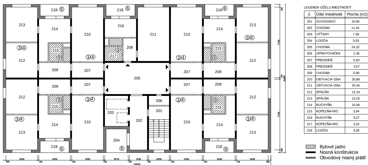
Obr. 4.19.11 Lokalizácia jednoduchých zásahov vo vežovom dome PS-82-PP
