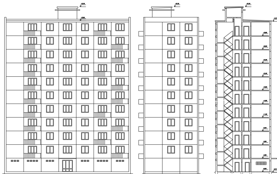
Obr. 4.4.5 Pohľady a rez bytovým domom MS 11
