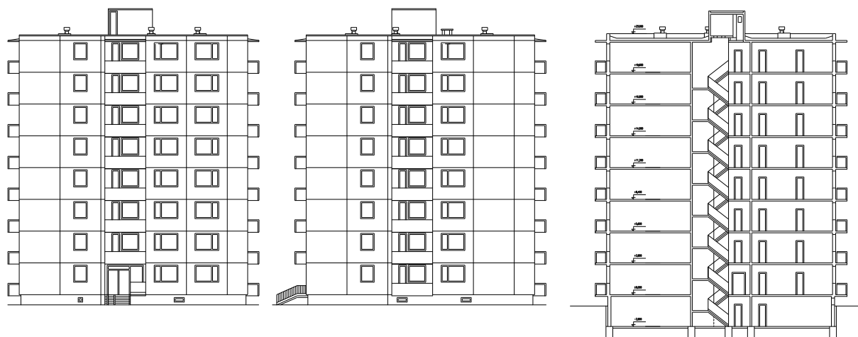
Obr. 4.8.4 Pohľady a rez bodovým domom T06B BA
