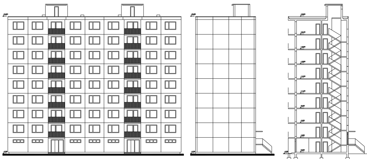
Obr. 4.19.4 Pohľad a rez radovým domom PS-82-PP
