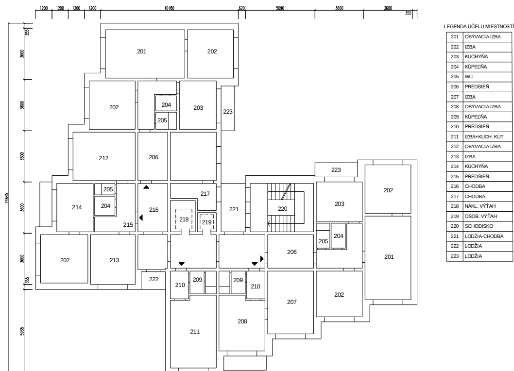
Obr. 4.5.9 Pôdorys typického podlažia vežového domu T 06 B ZA
