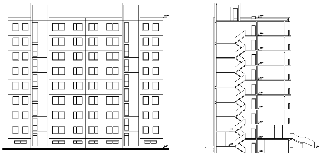
Obr. 4.18.3 Pohľad a rez radovým domom P1.15
