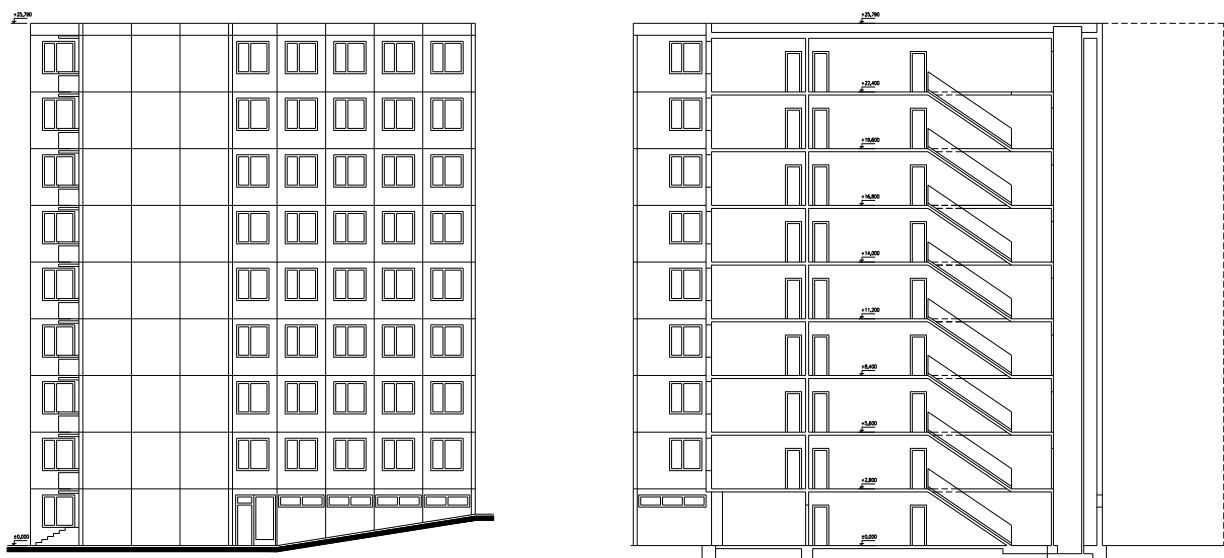
Obr. 4.14.4 Pohľad a rez bodovým domom B-70
