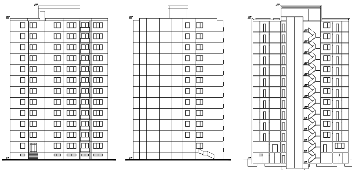
Obr. 4.17.4 Pohľad a rez bodovým domom P1.14 - 7. SRP
